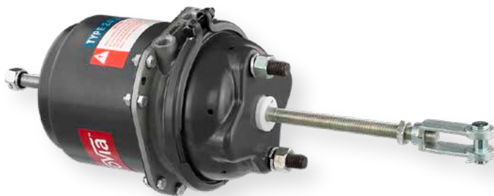
Ενεργοποιητής φρένων με ελατήριο για εκκεντροφόρα φρένα
