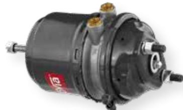
Пружинный энергоаккумулятор для дисковых тормозов
