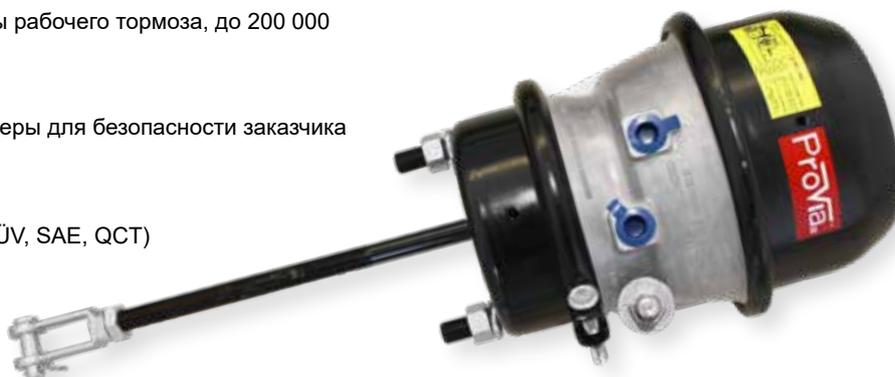
Двухмембранный пружинный энергоаккумулятор для барабанных тормозов
