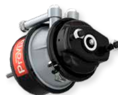
Dvoumembránový pružinový brzdový válec pro kotoučovou brzdu s prodlužovací trubkou
